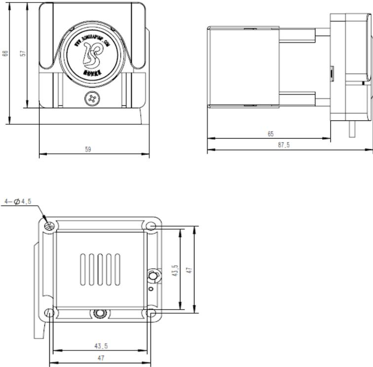
用户将压块组件拆开，拆下卡管座上的螺钉，取下卡管座，用 4 支 M3 螺钉将泵头固定在安装板上。
