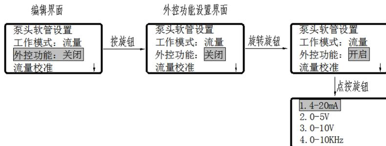
操作说明：此功能只能在流量模式下设置，进入【编辑界面】后再点按【外控功能】，旋转旋钮选择“关闭”、“开启”。
