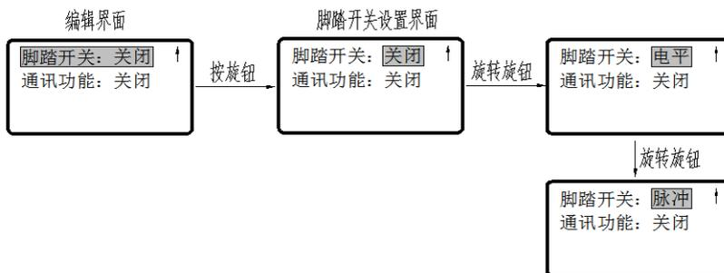
操作说明：进入【编辑界面】后再点按【脚踏开关】，进入【脚踏开关设置界面】，旋转旋钮按需求设置“关闭”、“电平”、“脉冲”。
