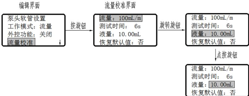
操作说明：进入【编辑界面】后再点按【流量校准】，进入【流量校准界面】，按需求可修改测试时间，此时【液量】数据为理论液量，按启动测试，测试完成后，修改【流量】数据为实测数据，点按旋钮确认即可。
