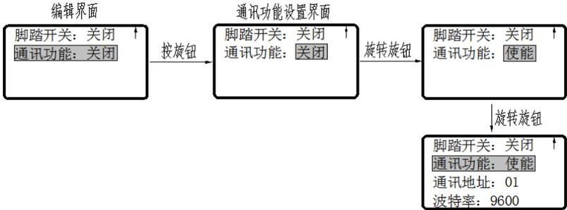
操作说明：进入【编辑界面】后再点按【通讯功能】，进入【通讯功能设置界面】，旋转旋钮按需求设置“关闭”、“使能”。
