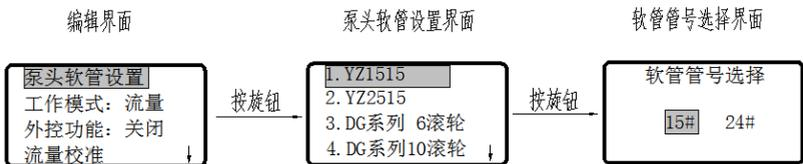
操作说明：在【工作界面】下，点按旋钮进入【编辑界面】，再点按【泵头软管设置】，旋转旋钮选择泵头型号，点按旋钮确认后进入【软管管号选择界面】，旋转旋钮选择后点按旋钮确定。
